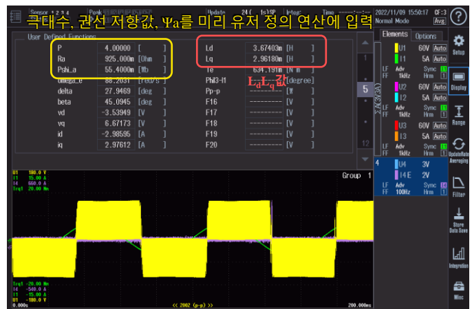
그림9 WT5000에서 dq 축 파라미터 측정 예 (Z상 신호의 파형은 채널4에서 측정)
