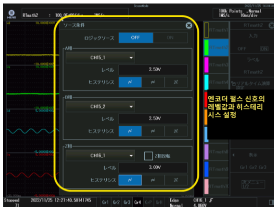
그림 13 DL950에서 A, B, Z 상 신호 측정 시 설정과 측정 예
