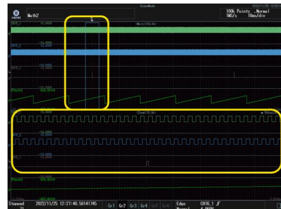
그림 13 DL950에서 A, B, Z 상 신호 측정 시 설정과 측정 예
